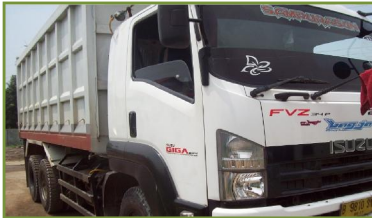
Gbr.1 Dump Truck memakai Deltalube 757 SAE 40 kapasitas OLI 20 Liter
